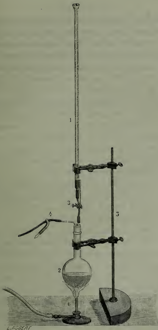
FIG. 407. — Ballon et burette pour le dosage du sucre.
